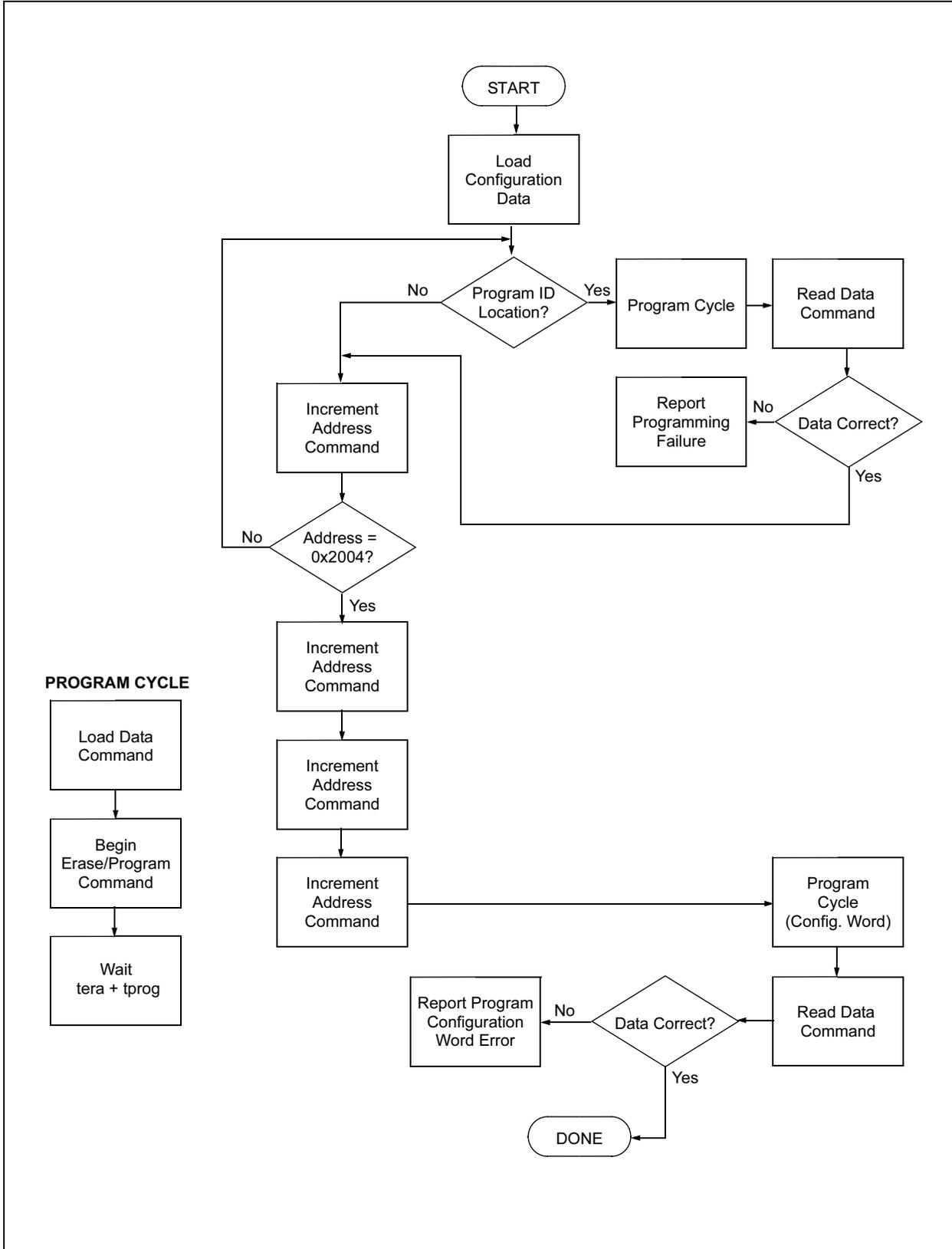
**FIGURE 2-4: FLOW CHART - PIC16F87X CONFIGURATION MEMORY**
