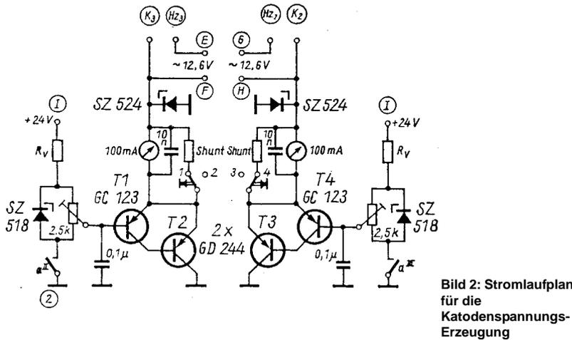
Bild 2: Stromlaufplan für die Katodenspannungserzeugung
