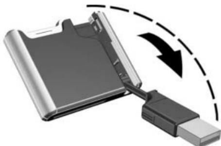
2. Steek de USB-connector van de digitale drive in een USB-poort van uw computer.
