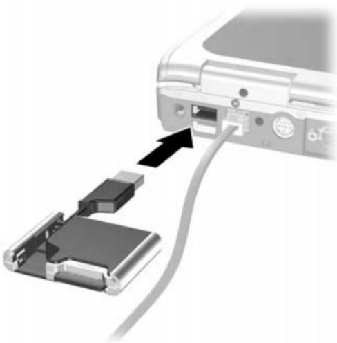
La luz de estado de la Unidad digital se enciende cuando la conexión está correcta. Si la luz de estado no se enciende, extraiga la Unidad digital del puerto USB y luego reinserte el conector USB.
