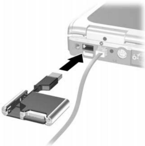
Die Statusanzeige am Digital Drive leuchtet auf, wenn die Verbindung erfolgreich hergestellt wurde. Wenn die Statusanzeige nicht aufleuchtet, trennen Sie das Digital Drive vom USB-Anschluss, und stecken Sie den USB-Stecker erneut ein.
