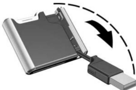
2. Inserte el conector USB de la Unidad digital en un puerto USB de la computadora.
