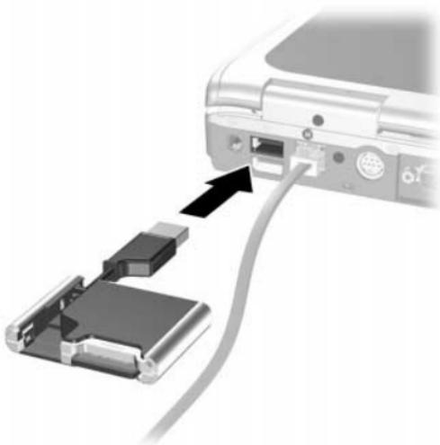
Het statuslampje op de digitale drive gaat branden als de drive goed is aangesloten. Als het statuslampje niet gaat branden, verwijdert u de digitale drive uit de USB-poort en sluit u de USB-connector vervolgens opnieuw op de poort aan.
