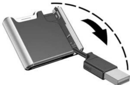
2. デジタル ドライブのUSBコネクタを、コンピュータのUSBポートに差し込みます。
