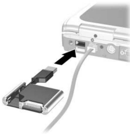
當連接成功時，Digital Drive 的狀態燈會亮起。如果狀態燈未亮起，請先將 Digital Drive 從 USB 連接埠移除，再重新將 USB 連接器插入。
