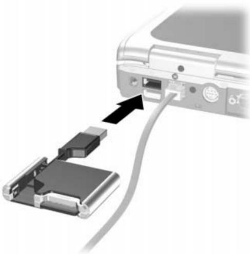
La spia di stato sul Digital Drive si accende quando la connessione viene stabilita correttamente. Se la spia di stato non si accende, rimuovere l'unità dalla porta USB, quindi reinserirre il connettore USB.
