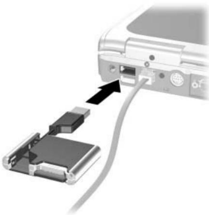
如果连接成功，数码驱动器上的状态指示灯将亮起。如果状态指示灯不亮，请从 USB 端口中取下数码驱动器，然后再重新安插 USB 连接器。
