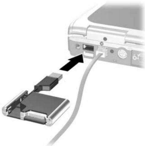
正しく接続されると、デジタル ドライブのステータス ランプが点灯します。ステータス ランプが点灯しない場合は、USBポートからデジタル ドライブを抜いて、USBコネクタを差し込みなおします。
