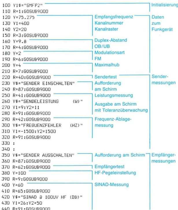
Beispiel eines Meßprogramms für ein Funkgerät, unter Zuhilfenahme der Grundsoftware SMFP2-K1
