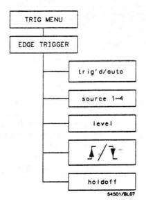
Figure 6-1. Edge Trigger Menu
