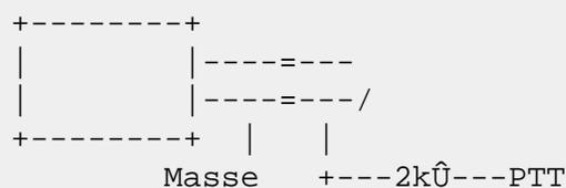
Der Masseanschluß und die Verbindung der PTT geschieht über die 2,5mm-Klinken- buchse an der Oberseite des TRX (eigentlich für externes Mic gedacht). Die PTT wird über einen 2 Kiloohm-Widerstand an die Spitze des Klinkensteckers gelötet. Die Masse wie immer an den anderen Anschluß des Steckers.
